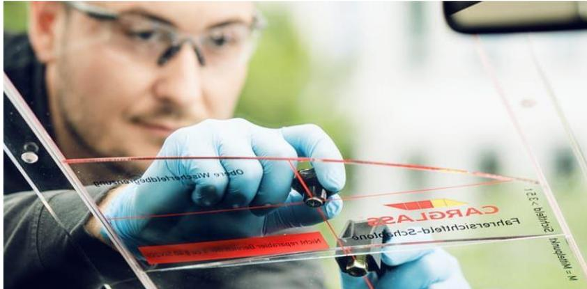
*Bildinformation: Die professionelle Reparatur eines Steinschlags ist möglich, wenn weniger als drei Steinschläge vorliegen, der Schaden kleiner als eine Zwei-Euro-Münze ist und die Schadstelle mindestens zehn Zentimeter vom Scheibenrand entfernt liegt.*
